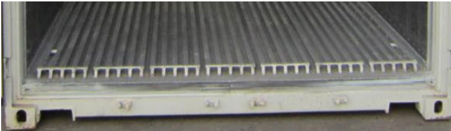
Fotó: a rakfelület visszaáll a hűtőteres jármű vastag, hőszigetelt raktérajtói miatt
