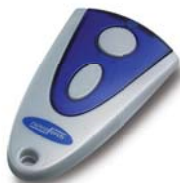
Mini-Novotron 502 2-csatornás, 433 MHz, KeeLoq-váltókód
