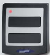
Signal 111 beltéri kapcsoló 2 csatornás, 433 MHz, Keeloq váltókos, 2 hajtás vagy 1 hajtás és külső világítás kapcsolására
